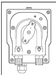
Prima di spegnere il sistema a fine stagione o comunque per un lungo periodo, dosare acqua pulita in modo da sciacquare il tubo, quindi posizionare il porta-rullini come mostrato in figura, ruotandolo in senso orario.
