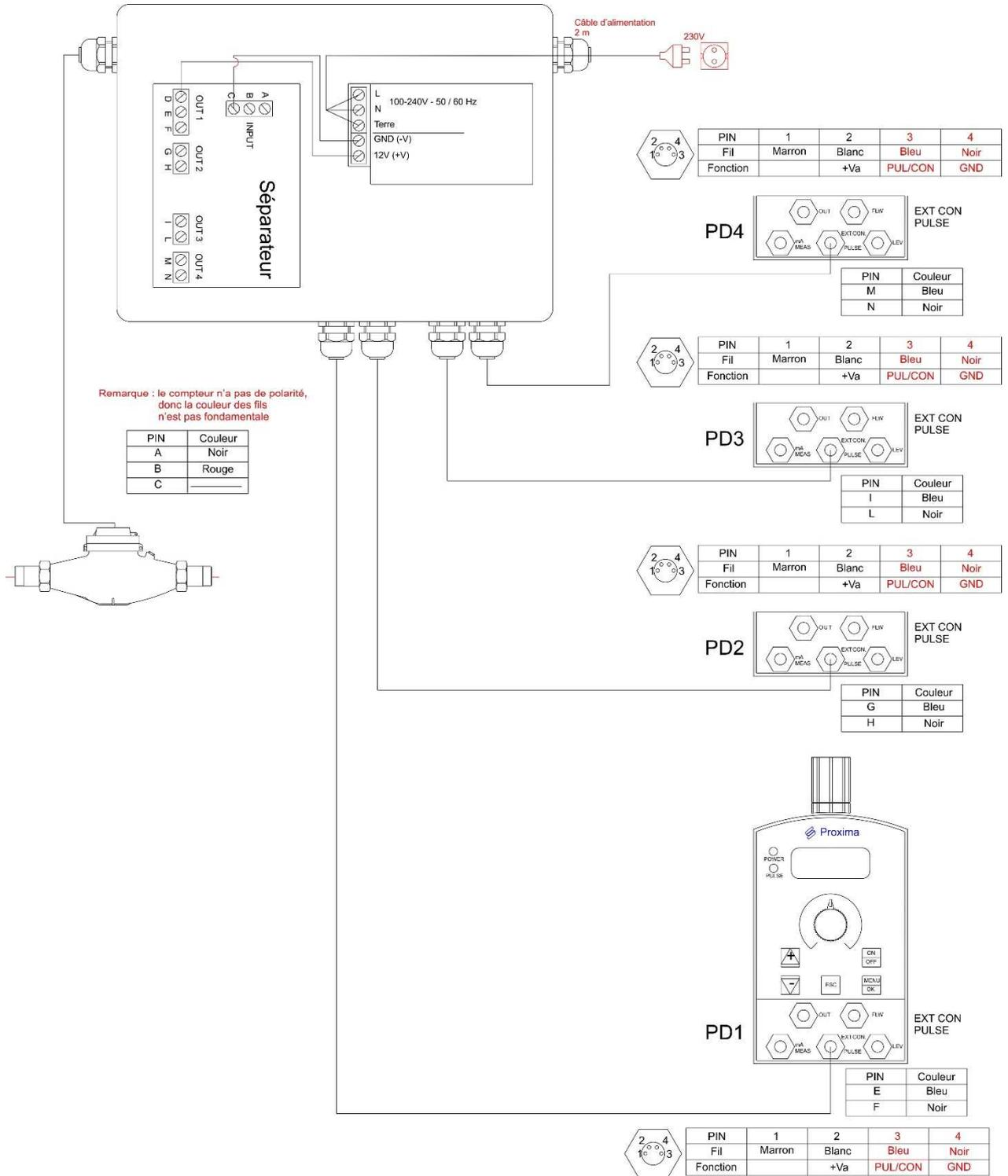
**Schéma de connexion pour un séparateur avec alimentation intégrée, entrée d'un capteur de débit et commande pour pompes série PSP**
