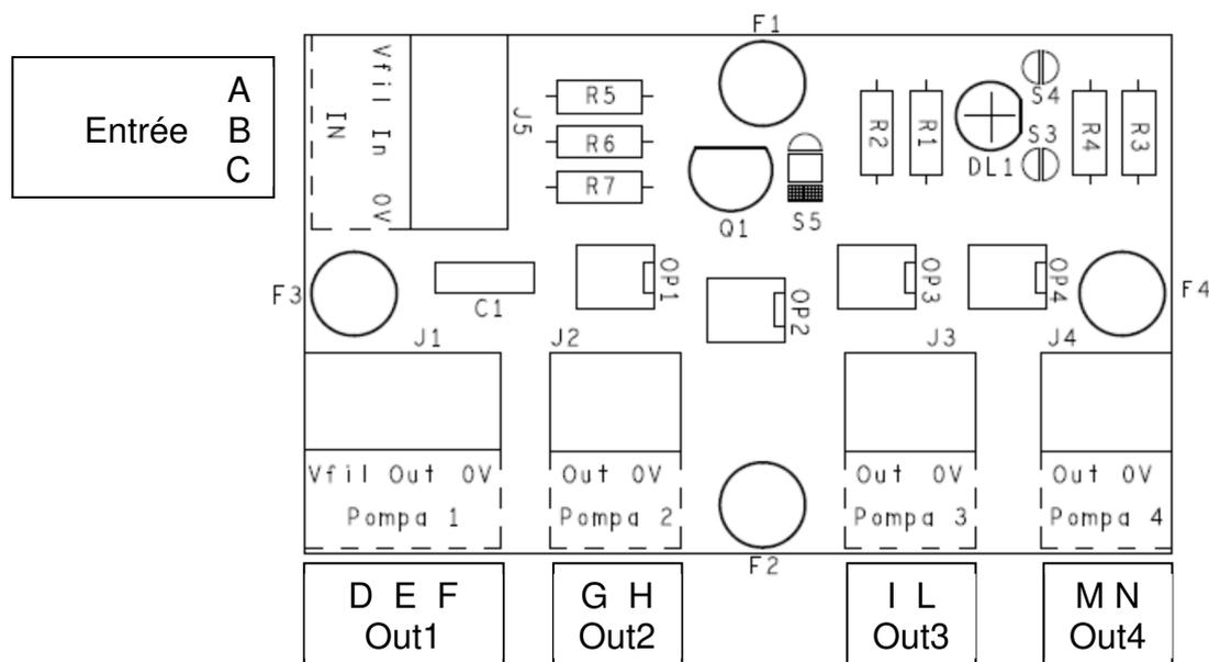
Entrée: en fonction du type de capteur, établissez les connexions décrites ci-dessous :
