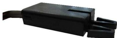
**Nota importante:** Se è necessario rimuovere il cavo, piegare le clips con l'aiuto di un cacciavite e spingere fuori il connettore. Eseguire questa operazione con molta attenzione, perché le clips del connettore si possono facilmente rompere.
